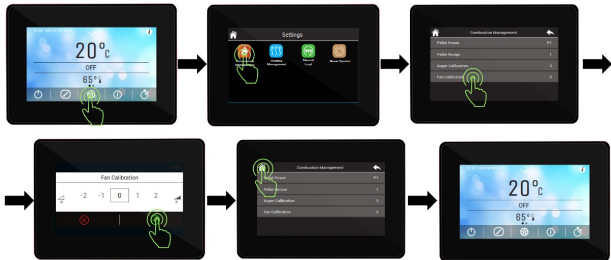
Slika 28. Spreminjanje časa doziranja črvastega transporterja
