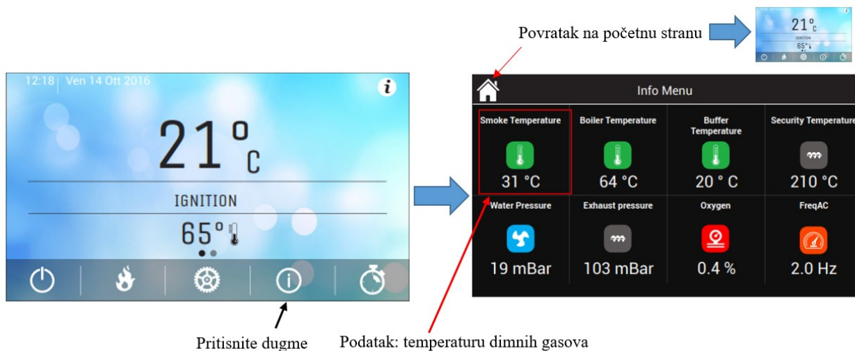
Slika 31. Odčitavanje temperature dimnih plinov
