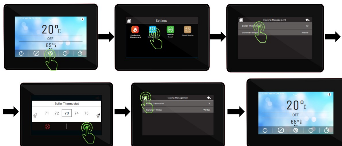
Slika 30. Odčitavanje nameštene temperature
