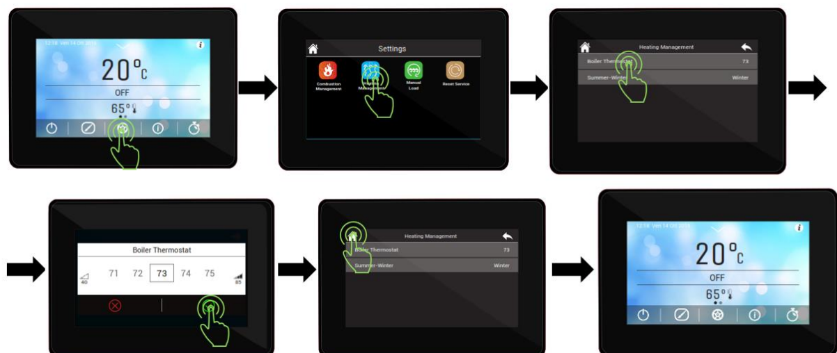
Slika 29. Promena zadate temperature vode u kotlu
