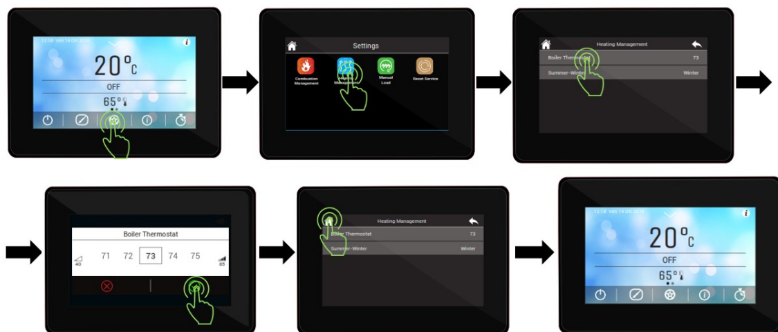
Slika 29. Promena zadate temperature vode u kotlu
